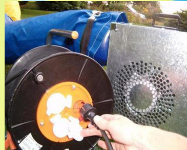
Stap 3. Steek de stekker van de ventilator in een geaard stopcontact.
